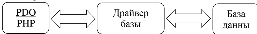
Рис. 25. Взаимодействие PHP-сценария с базой данных с помощью расширения PDO
