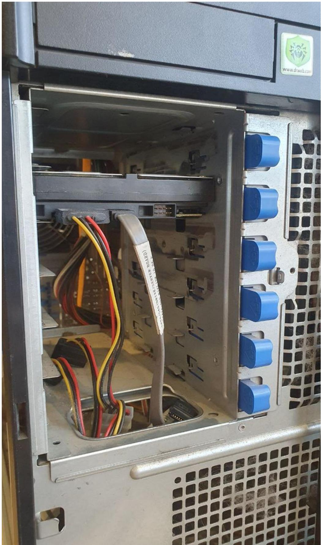
Рисунок А3 – Салазки для установки жестких дисков
