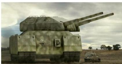
1000 тонн. Это при том, что обычный немецкий танк «Тигр» весил лишь 60 т. Супертанк хотели назвать «Крысой» (рис. П2.3.) Его длина должна была составлять 35 метров. На вооружение предполагалось установить 280-мм орудие.
