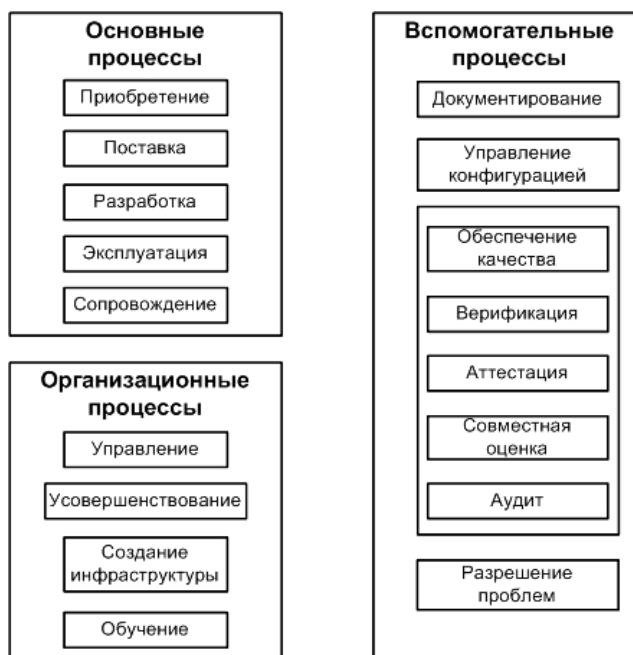
Рис. 2.2 Структура процессов жизненного цикла программного обеспечения
