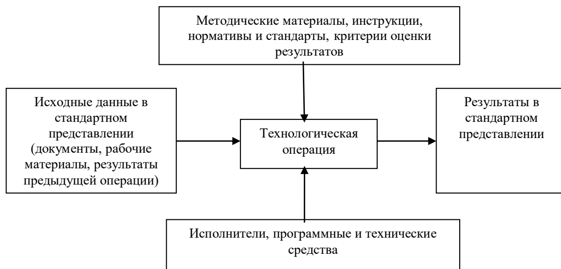
Рис. 1.1 Структура описания технологической операции
