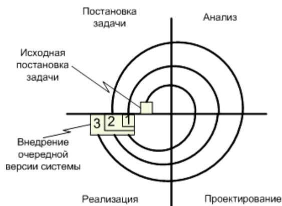
Рис. 2.5 Спиральная или итерационная схема разработки программного обеспечения
