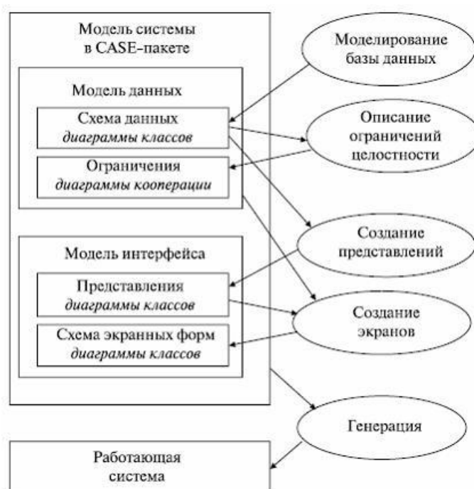
Рис. 24. Модель системы в технологическом CASE-решении
