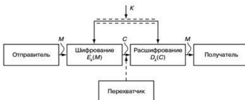
Рис.1.10. Схема симметричной криптосистемы с закрытым ключом
