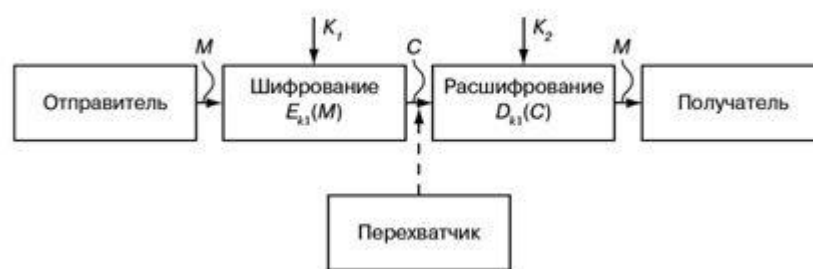
Рис.1.11. Схема асимметричной криптосистемы с открытым ключом
