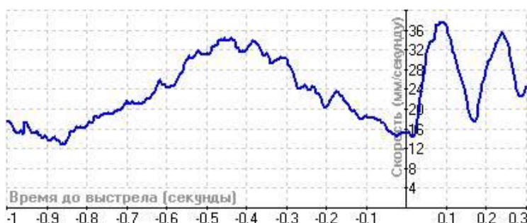
Рисунок 11 - На графике показано изменение скорости движения траектории за одну секунду перед выстрелом.
